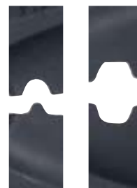
Прижатие наконечника к трубке боуденовского троса
