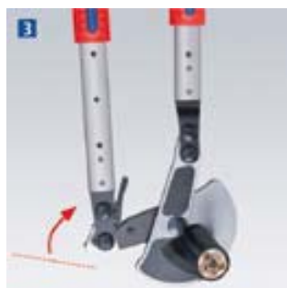
Настройка удобного расстояния между ручками
