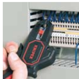
Удаление изоляции в стесненных условиях
