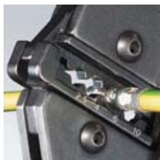
97 43 200 с матрицей опрессовочной 97 49 30 для неизолированных плоских контактов
