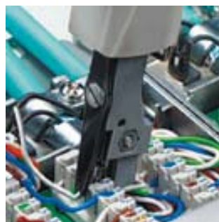
Опрессовка и резание кабеля в одной операции
