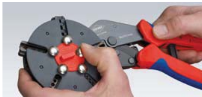
Смена профилей опрессовки: разблокируйте положение магазина, выньте профиль опрессовки из клещей
