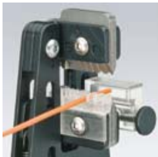
12 12 02 с направляющей для кабеля и ограничителем длины
