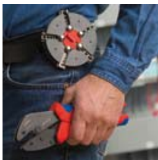
Возможна носка магазина для профилей опрессовки на поясе
